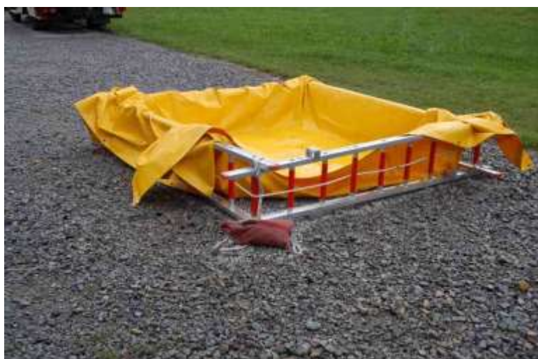
Abbildung 15, Auffangbehälter aus vier Steckleiterteilen
