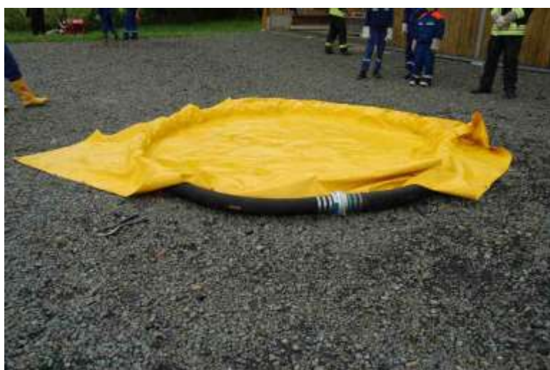
Abbildung 16, Auffangbehälter aus sechs A-Saugschläuchen
